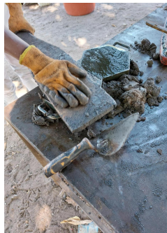
Het smeltende plastic wordt met zand gemengd. Daarna gaat het in een mal en wordt het stevig aangedrukt.
