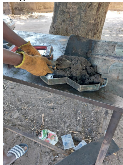
Het smeltende plastic wordt met zand gemengd. Daarna gaat het in een mal en wordt het stevig aangedrukt.
