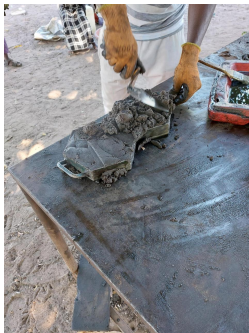
Het smeltende plastic wordt met zand gemengd. Daarna gaat het in een mal en wordt het stevig aangedrukt.
