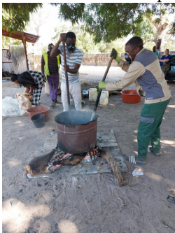
Het smeltende plastic wordt met zand gemengd. Daarna gaat het in een mal en wordt het stevig aangedrukt.
